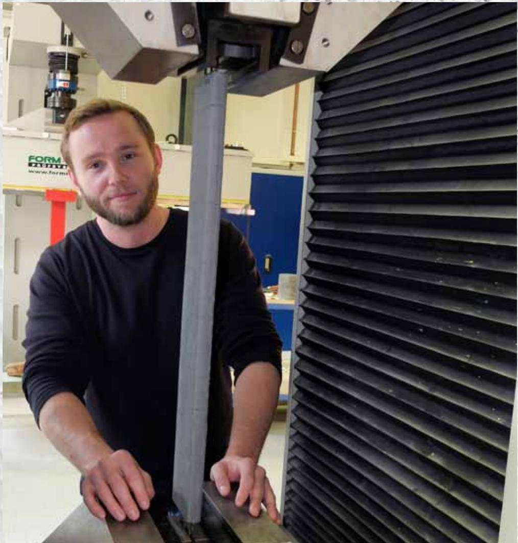
**Jan Rebling (wissenschaftlicher Mitarbeiter) bei der Laborarbeit: An der Universalprüfmaschine können Probekörper aus bewehrtem Beton auf ihre Belastbarkeit geprüft werden.**
