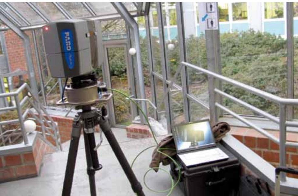
Die Angaben zur Genauigkeit sind vom Gerätehersteller verknüpft mit den Kennwerten des Gerätes. Aktuell gibt es noch keine festgelegten Prüfrichtlinien für terrestrische Laserscanner. Es obliegt dem Hersteller, in welcher Form er Auskunft über die Genauigkeit seines Gerätes gibt.
