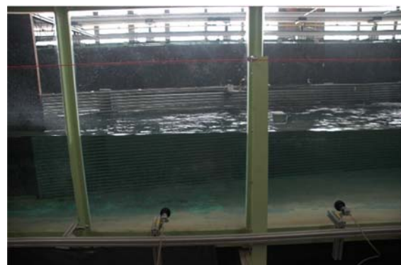
Abbildung 12: Fischbeobachtungsrinne mit kalibrierten Videokameras
