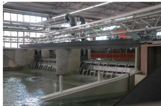
Abbildung 11: Eines der vielen Modelle in der Forschungshalle des BAW - Steuerbare Wehranlage
