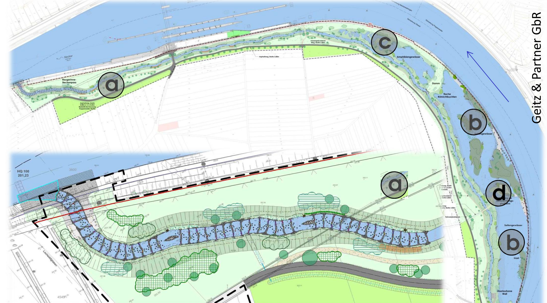
Umgehungsgerinne (a), Seitengewässer (b), Amphibiengewässer (c) und Besucherinsel (d) im Gesamtanlageplan der Renaturierungsmaßnahmen
