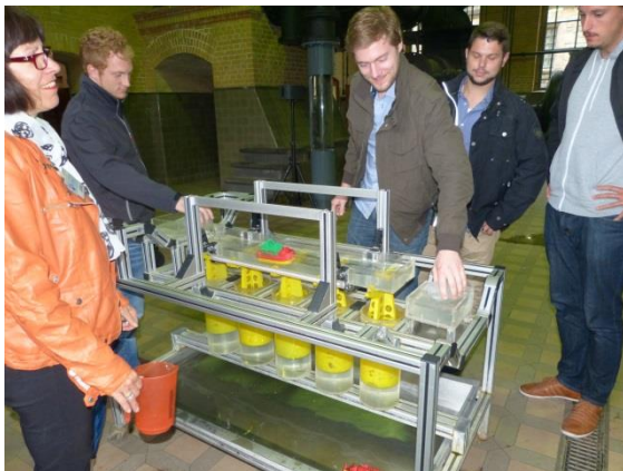
Abb. 17: Prinziperläuterung am Modell eines Schiffshebewerks
