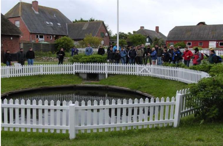
Da aber bis in die 60er keine Trinkwasserleitungen vorhanden waren, wurden Fethings erstellt, welche als Viehtränke dienten und mit Aufbereitung durch Zisternen auch für die Trinkwasserpeicherung und Nutzung verwendet werden konnte.
