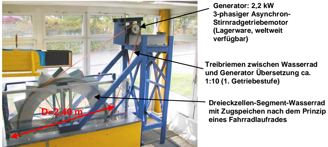
1,0 kW-Prototyp des Dreieckzellen-Segment-Wasserrades im Wasserbaulabor der fwu
