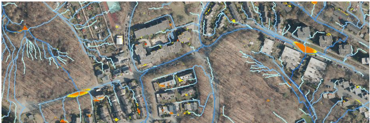
Abbildung: Ausschnitt der Ergebnisse der Fließweganalyse: Geländesenken (gelb-orange) und potenzielle Fließwege (blau)
