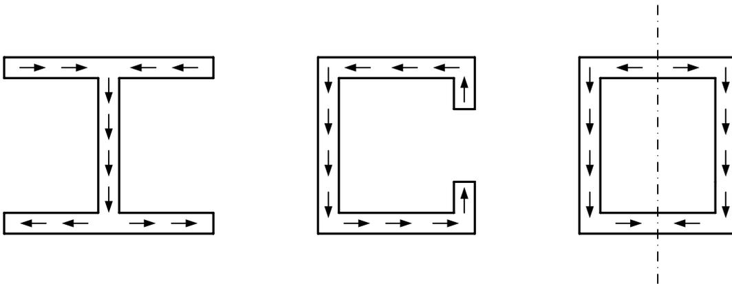
Die Wahl der Profilkoordinate  $s$  ist frei. Sinnvoll ist es aber,  $s$  so einzuführen, dass sie dem Verlauf des Schubflusses entspricht.
