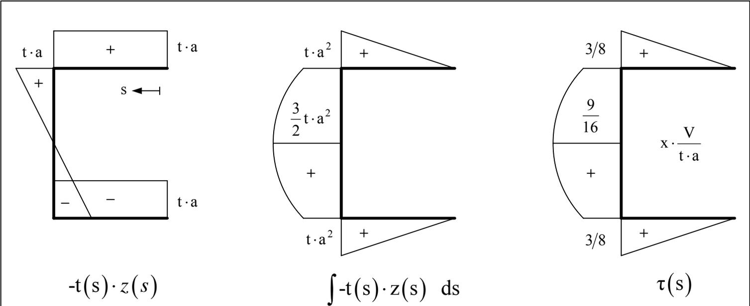
Schubspannungsverlauf einiger Querschnitte:
