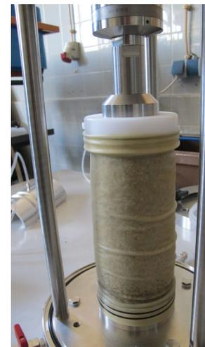
In dieser Arbeit sollen für ausgewählte Böden die Scherparameter an dem am Lehrstuhl für Geotechnik vorhandenen vollautomatischen Triaxialgerät der Fa. Geomotion unter variablen Randbedingungen untersucht werden, darunter auch der Einfluss unterschiedlicher Probengrößen.
