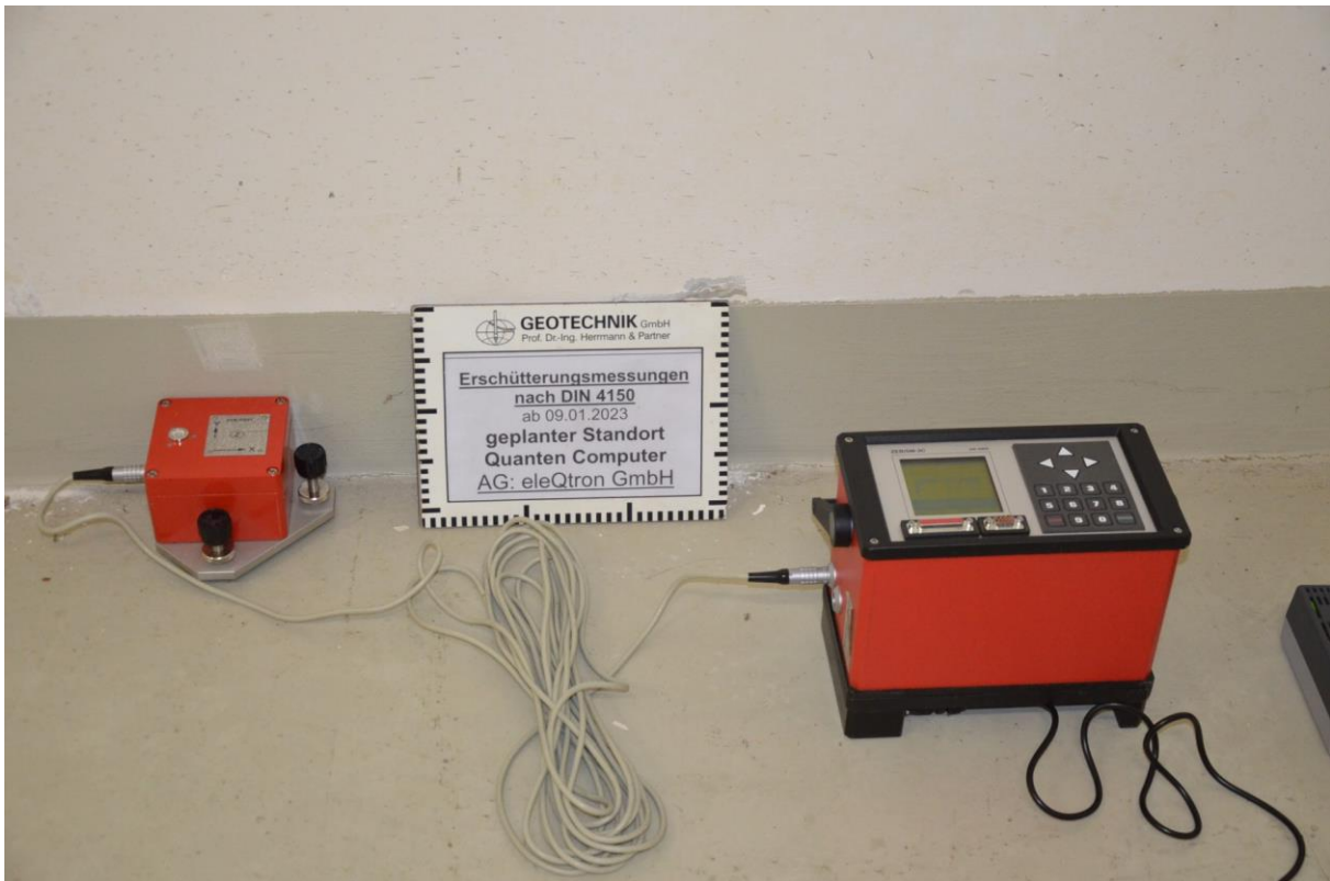
Abbildung 2-37: Erschütterungsmessungen am geplanten neuen Standort eines Quantencomputers benachbart zum Hauptbahnhof Siegen
