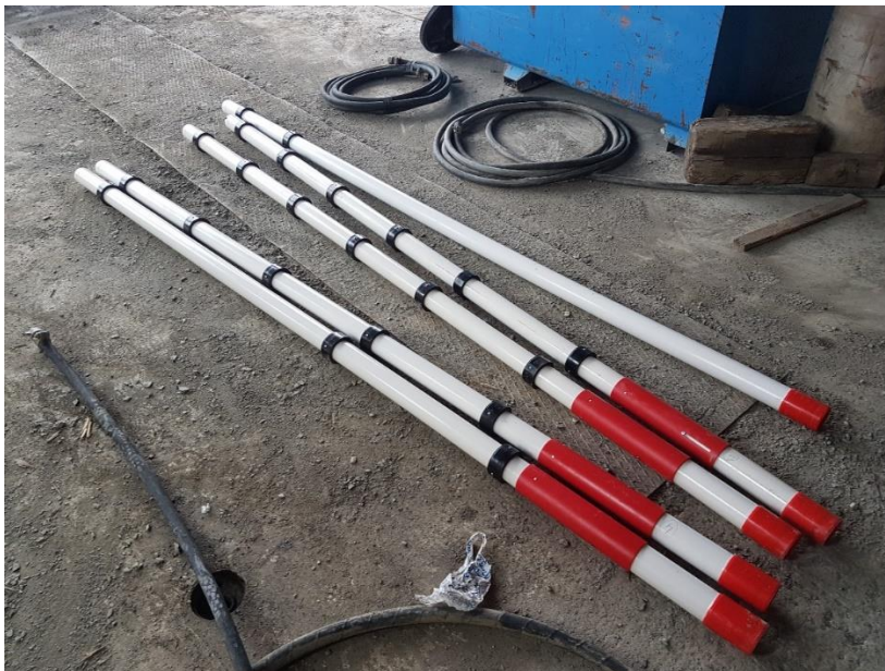
Abbildung 5.3: Inklinometer-Extensometer-Messrohre an die die Thermistoren-Messketten befestigt wurden
