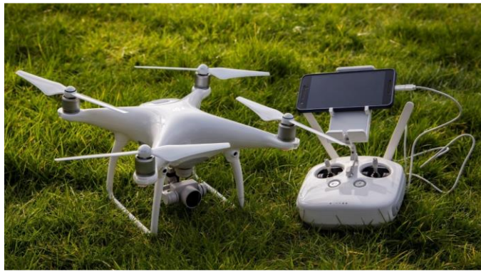
Abbildung 2-5: Equipment für UAV-Photogrammetrie.
