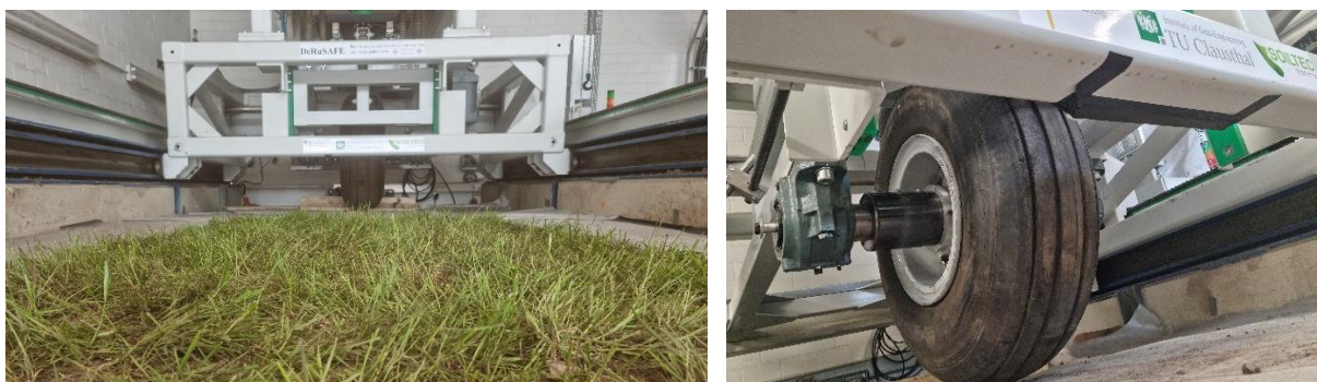
Abbildung 5: Überfahrversuchsstand mit Einbau eines begrünten Streifens (links) und Bugrad eines A320 (rechts)
