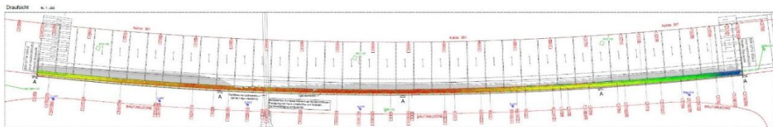
Abbildung 3-11: Abwicklung Gesamtbauwerk Ergebnisse Vertikalverformungen (UAV).
