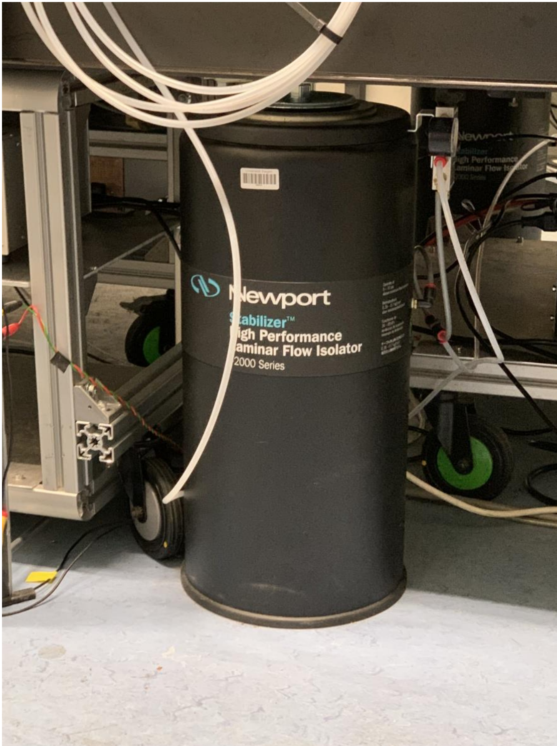
Abbildung 2-39: Dämpfersystem gegen vertikale Schwingungen am bestehenden Quantencomputer der Universität Siegen
