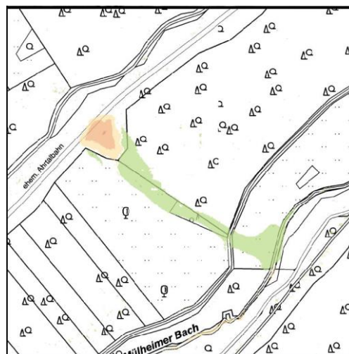
Abbildung 4-2 Differenz-DGM der Rutschung; rot negative Geländebewegungen; grün positive Geländebewegungen
