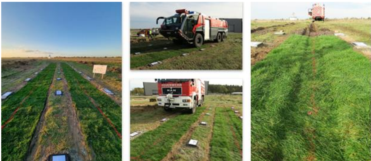
Abbildung 9: Überfahrversuche Panther 6x6 und Buffalo 6x6 auf Teststrecke bestehend aus Geoverbundstrukturen
