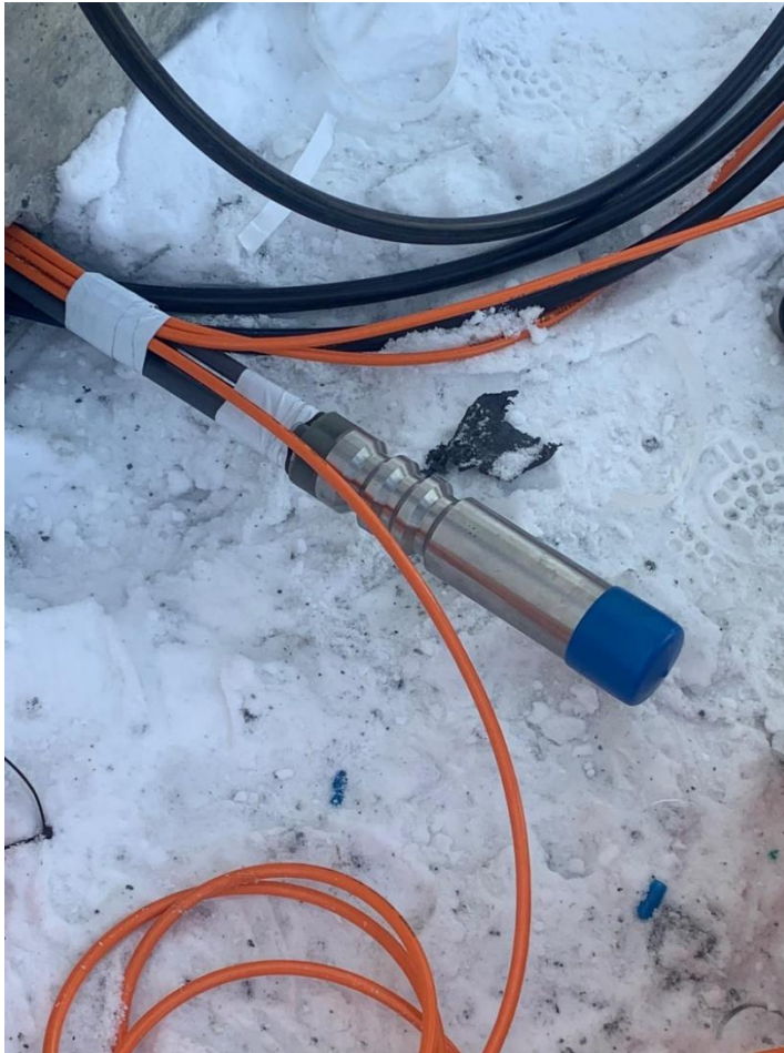
Abbildung 4.6: Extensometer-Messkopf mit elektrischen Wegaufnehmern
