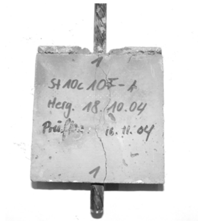
Bild 3.20 Längsrissbildung bei reduzierter Betondeckung (hier: c = 1,0 d_s )
