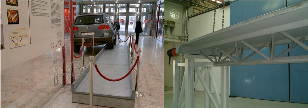
Bild 8 a: Fußgängersteg mit 6 m Länge und 3 cm Plattendicke, hergestellt im eigenen Labor
