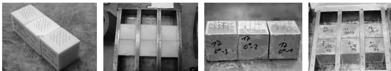
Bild 11. Schalung und Probekörper der Fasergruppen [12].
