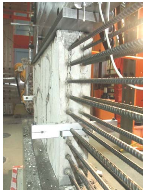
Bild A.2-114. Bruchbild der Scheibe F250VK (Ansicht West) Fig. A.2-114. Panel F250VK at failure (view west)
