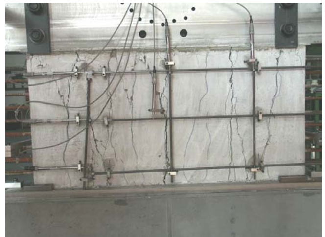
Bild A.1-89. Bruchbild der Scheibe F250T (Ansicht Süd) Fig. A.1-89. Panel F250T at failure (view south)
