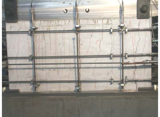
Bild A.1-71. Rissbild der Scheibe F075T (Ansicht Süd) Fig. A.1-71. Crack pattern of Panel F075T (view south)
