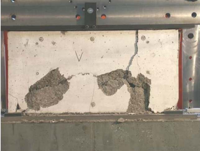
Bild A.2-10. Bruchbild der Scheibe VK3 (Ansicht Nord) Fig. A.2-10. Panel VK3 at failure (view north)
