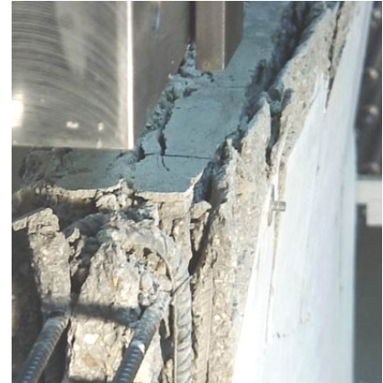
b) Aufspalten des Scheibenkopfs der Scheibe 000T b) splitting of the head of Panel 000T
