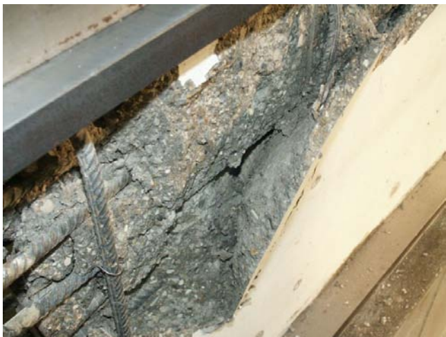
Bild A.2-21. Bruchbild der Scheibe 000VK1 (Ansicht Nord) Fig. A.2-21. Panel 000VK1 at failure (view north)
