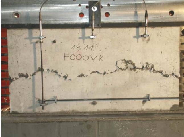
Bild A.2-79. Bruchbild der Scheibe F000VK (Ansicht Nord) Fig. A.2-79. Panel F000VK at failure (view north)
