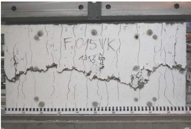
Bild A.4-69. Bruchbild der Scheibe F015VK (Ansicht Süd) Fig. A.4-69. Panel F015VK at failure (view south)
