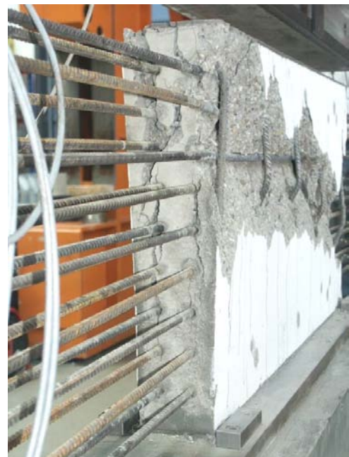
Bild A.4-36. Bruchbild der Scheibe 025VK (Ansicht West) Fig. A.4-36. Panel 025VK at failure (view west)
