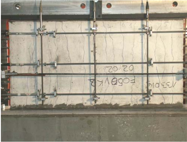
Bild A.3-26. Rissbild der Scheibe F050VK2 (Ansicht Nord) Fig. A.3-26. Crack pattern of Panel F050VK2 (view north)
