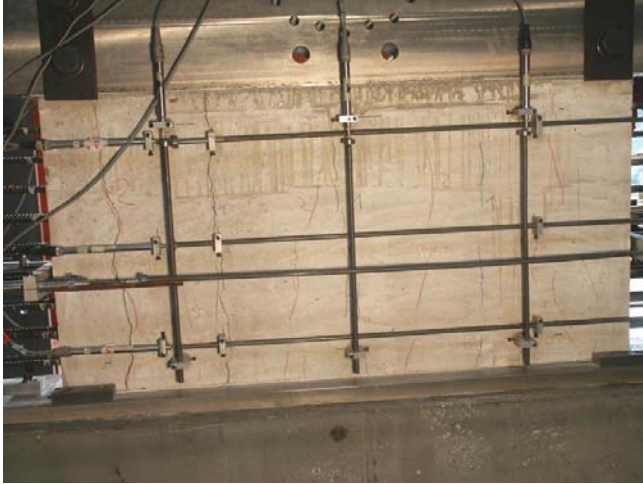
Bild A.1-22. Rissbild der Scheibe 050T (Ansicht Nord) Fig. A.1-22. Crack pattern of Panel 050T (view north)
