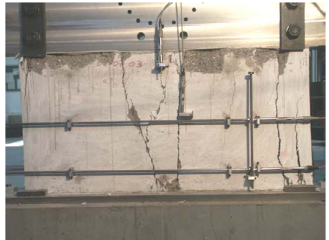
Bild A.1-92. Bruchbild der Scheibe T (Ansicht Süd) Fig. A.1-92. Panel T at failure (view south)
