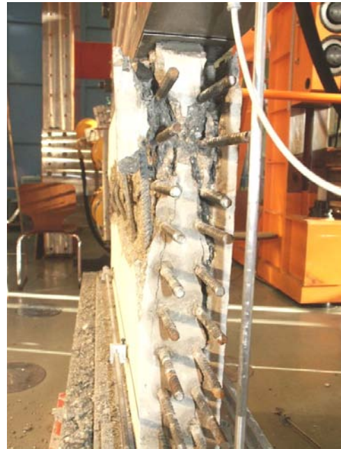
Bild A.2-117. Bruchbild der Scheibe 000 (Ansicht West) Fig. A.2-117. Panel 000 at failure (view west)
