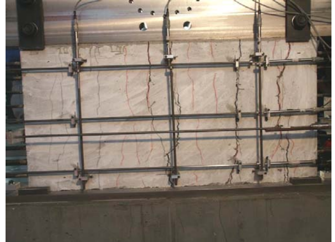
Bild A.1-109. Rissbild der Scheibe F150 (Ansicht Süd) Fig. A.1-109. Crack pattern of Panel F150 (view south)
