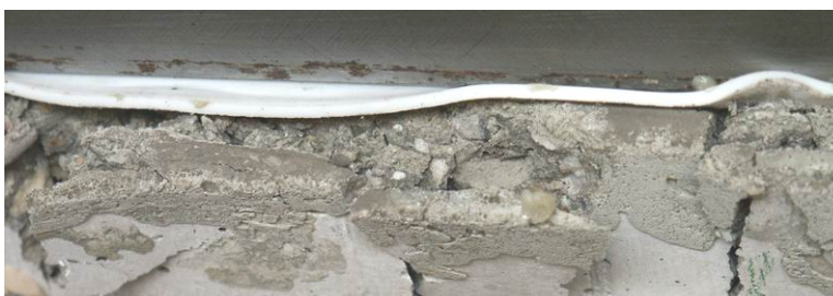
Bild 6-2. Typische Bruchbilder der Scheiben der Serie 1 Fig. 6-2. Typical failure patterns of the panels of Series 1
