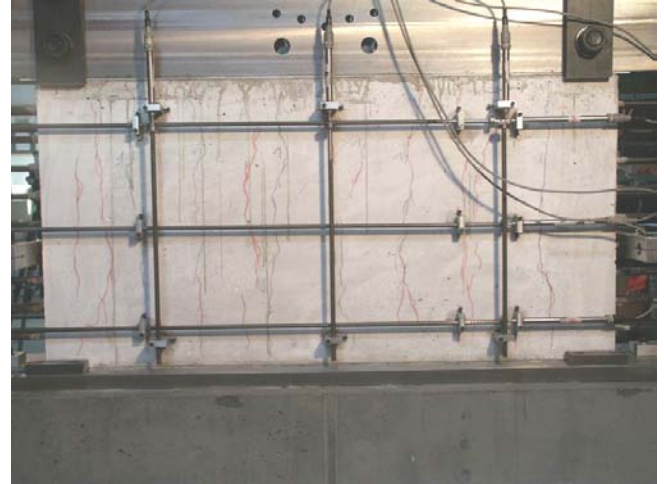
Bild A.1-57. Rissbild der Scheibe F025T (Ansicht Süd) Fig. A.1-57. Crack pattern of Panel F025T (view south)
