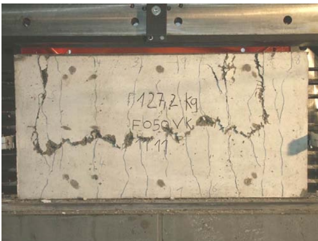
Bild A.2-105. Bruchbild der Scheibe F050VK (Ansicht Nord) Fig. A.2-105. Panel F050VK at failure (view north)
