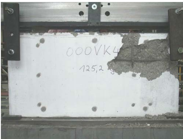
Bild A.4-11. Bruchbild der Scheibe 000VK4 (Ansicht Süd) Fig. A.4-11. Panel 000VK4 at failure (view south)
