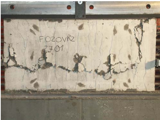
Bild A.3-20. Bruchbild der Scheibe F020VK2 (Ansicht Nord) Fig. A.3-20. Panel F020VK2 at failure (view north)
