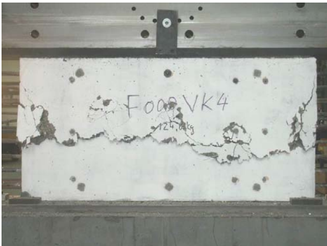
Bild A.4-61. Bruchbild der Scheibe F000VK4 (Ansicht Süd) Fig. A.4-61. Panel F000VK4 at failure (view south)
