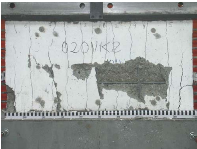
Bild A.4-27. Bruchbild der Scheibe 020VK2 (Ansicht Süd) Fig. A.4-27. Panel 020VK2 at failure (view south)
