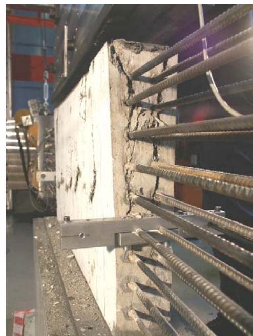
Bild A.2-106. Bruchbild der Scheibe F050VK (Ansicht West) Fig. A.2-106. Panel F050VK at failure (view west)
