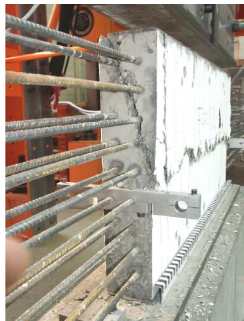
Bild A.4-78. Bruchbild der Scheibe F025VK (Ansicht Ost) Fig. A.4-78. Panel F025VK at failure (view east)
