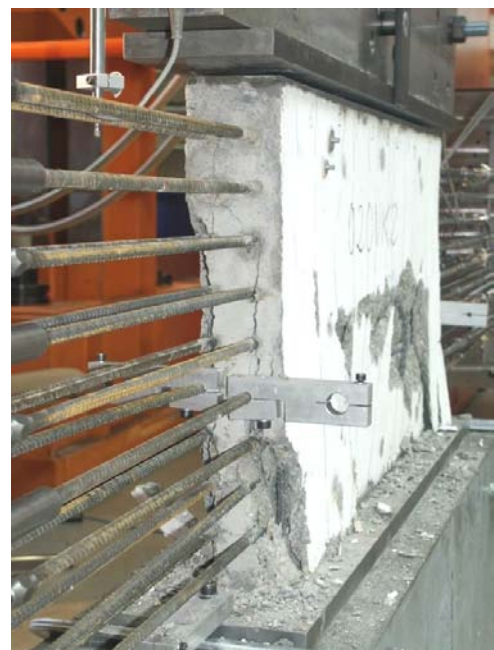
Bild A.4-28. Bruchbild der Scheibe 020VK2 (Ansicht Ost) Fig. A.4-28. Panel 020VK2 at failure (view east)
