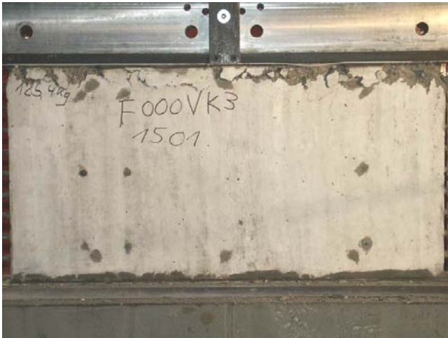
Bild A.3-8. Bruchbild der Scheibe F000VKT (Ansicht Nord) Fig. A.3-8. Panel F000VKT at failure (view north)
