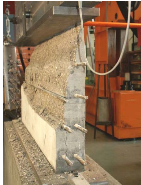
Bild A.2-122. Bruchbild der Scheibe Q000VK (Ansicht West) Fig. A.2-122. Panel Q000VK at failure (view west)
