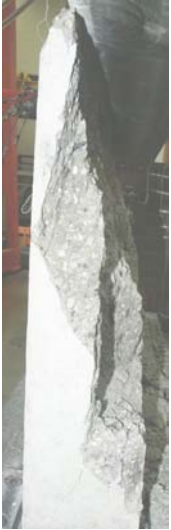
a) Schubbruch einer unbewehrten Betonscheibe a) shear failure of an unreinforced concrete panel
