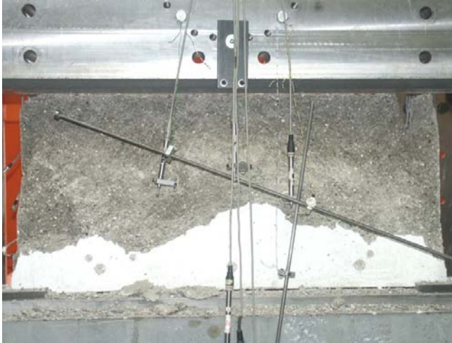
Bild A.2-2. Bruchbild der Scheibe VK1 (Ansicht Nord) Fig. A.2-2. Panel VK1 at failure (view north)
