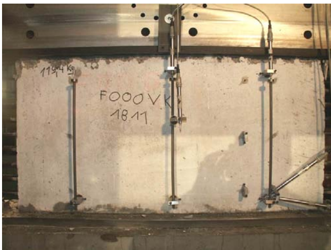
Bild A.2-81. Bruchbild der Scheibe F000VK (Ansicht Süd) Fig. A.2-81. Panel F000VK at failure (view south)
