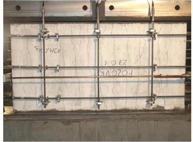
Bild A.3-19. Rissbild der Scheibe F020VK2 (Ansicht Süd) Fig. A.3-19. Crack pattern of Panel F020VK2 (view south)
