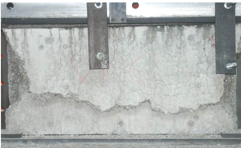
c) Schubbruch der nur auf Druck belasteten unbewehrten Scheibe VK6 c) shear failure of the plain concrete Panel VK6, loaded only in compression
