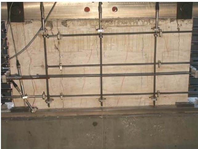
Bild A.1-24. Bruchbild der Scheibe 050T (Ansicht Nord) Fig. A.1-24. Panel 050T at failure (view north)
