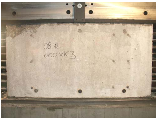
Bild A.2-31. Bruchbild der Scheibe 000VK3 (Ansicht Süd) Fig. A.2-31. Panel 000VK3 at failure (view south)
