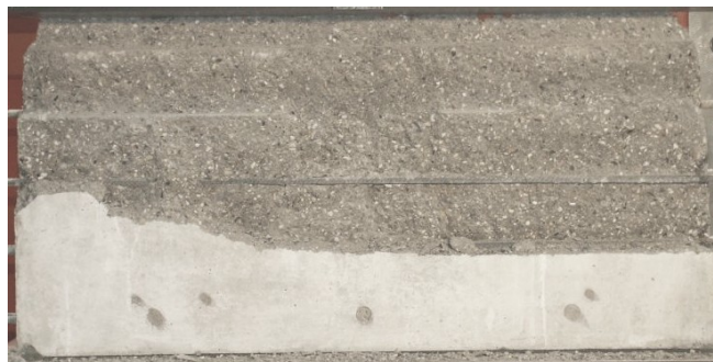
d) Bruchbild einer Scheibe ohne vertikale Bewehrung d) failure of a panel without vertical reinforcement
