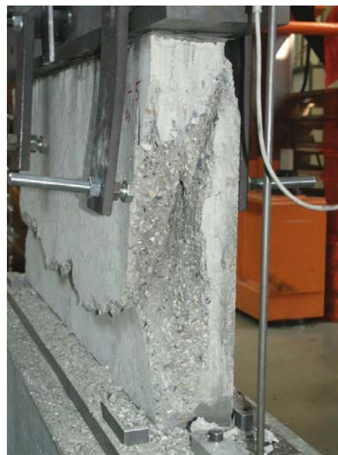
Bild A.4-7. Bruchbild der Scheibe VK6 (Ansicht West) Fig. A.4-7. Panel VK6 at failure (view West)
