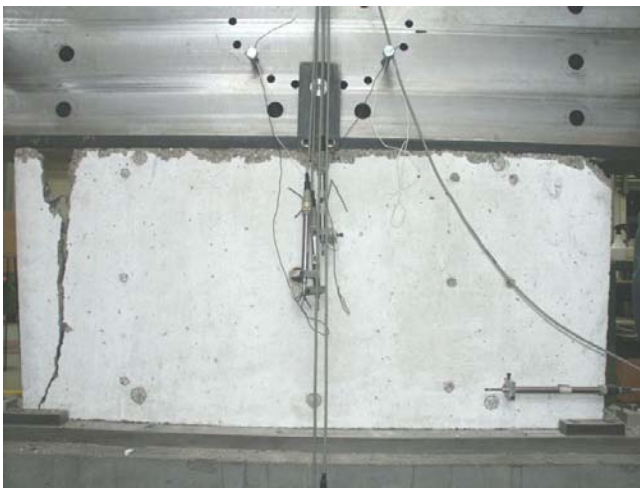
Bild A.2-4. Bruchbild der Scheibe VK1 (Ansicht Süd) Fig. A.2-4. Panel VK1 at failure (view south)
