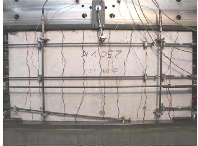
Bild A.2-70. Rissbild der Scheibe 250VK (Ansicht Süd) Fig. A.2-70. Crack pattern of Panel 250VK (view south)
