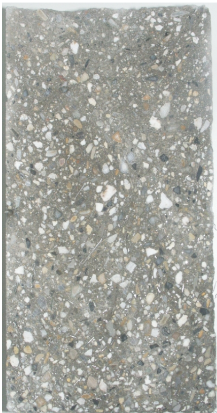
Bild 6-6. Schnittfläche eines Zylinders aus Stahlfaserbeton der Serie 2 mit deutlichen Entmischungserscheinungen
