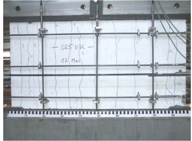
Bild A.4-34. Rissbild der Scheibe 025VK (Ansicht Süd) Fig. A.4-34. Crack pattern of Panel 025VK (view south)
