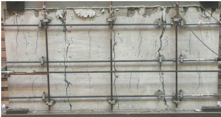
a) Stahlbetonscheibe 000T, nur auf Druck belastet, Bruch direkt unterhalb der PTFE-Folie a) reinforced concrete Panel 000T, loaded in compression only, failure directly beneath the PTFE-foil
