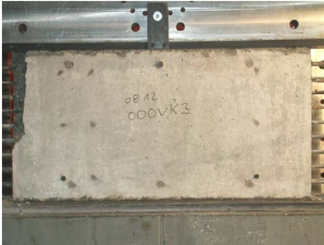
Bild A.2-29. Bruchbild der Scheibe 000VK3 (Ansicht Nord) Fig. A.2-29. Panel 000VK3 at failure (view north)
