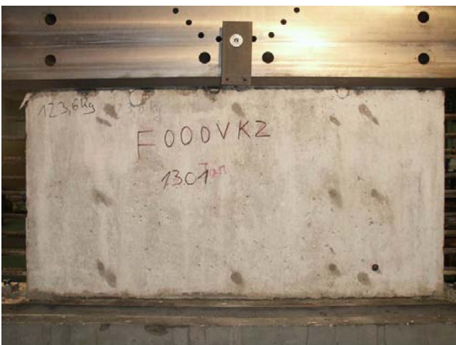
Bild A.3-4. Bruchbild der Scheibe F000VK2 (Ansicht Süd) Fig. A.3-4. Panel F000VK2 at failure (view south)
