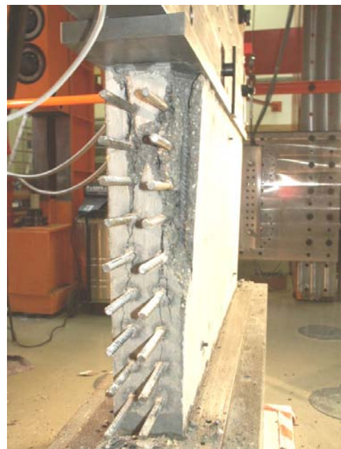
Bild A.2-32. Bruchbild der Scheibe 000VK3 (Ansicht Ost) Fig. A.2-32. Panel 000VK3 at failure (view east)
