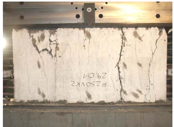
Bild A.3-37. Bruchbild der Scheibe F250VK2 (Ansicht Süd) Fig. A.3-37. Panel F250VK2 at failure (view south)
