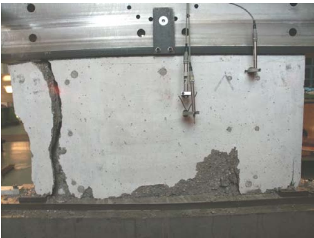
Bild A.2-12. Bruchbild der Scheibe VK3 (Ansicht Süd) Fig. A.2-12. Panel VK3 at failure (view south)
