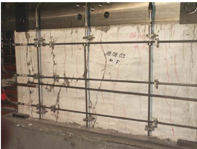
Bild A.1-110. Bruchbild der Scheibe F150 (Ansicht Nord) Fig. A.1-110. Panel F15T at failure (view north)
