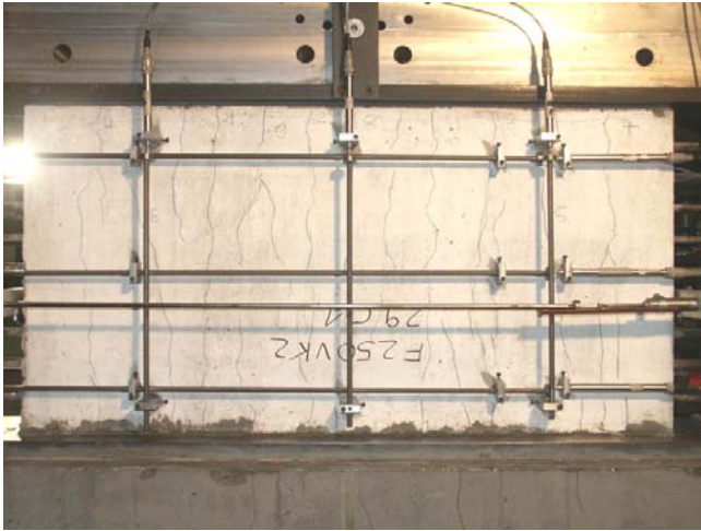
Bild A.3-34. Rissbild der Scheibe F250VK2 (Ansicht Nord) Fig. A.3-34. Crack pattern of Panel F250VK2 (view north)
