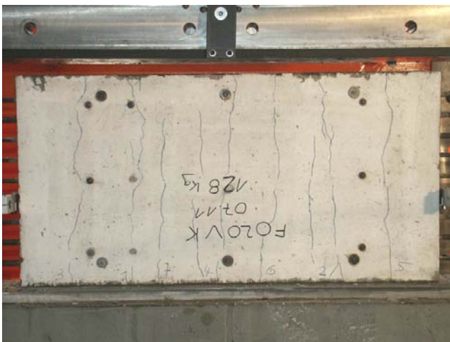
Bild A.2-97. Bruchbild der Scheibe F020VK (Ansicht Nord) Fig. A.2-97. Panel F020VK at failure (view north)
