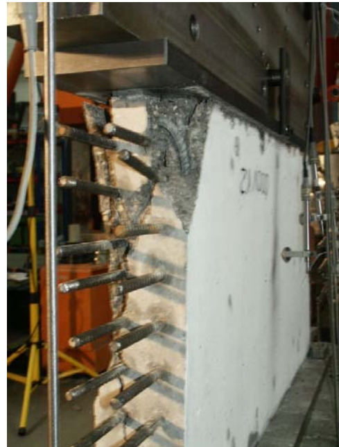
Bild A.2-20. Bruchbild der Scheibe 000VK1 (Ansicht West) Fig. A.2-20. Panel 000VK1 at failure (view west)
