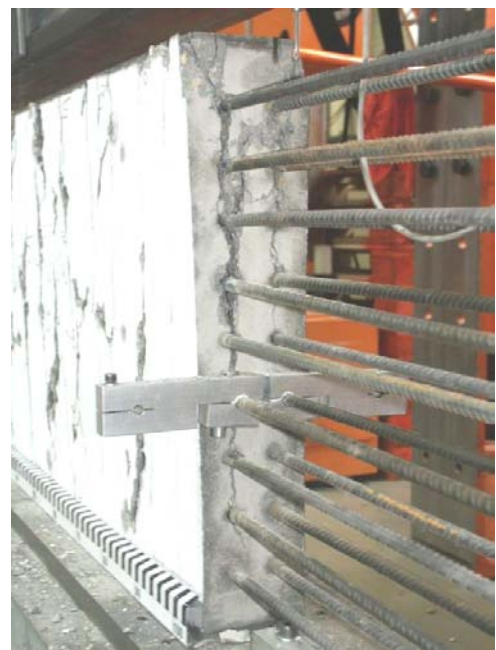
Bild A.4-52. Bruchbild der Scheibe 250VK2 (Ansicht West) Fig. A.4-52. Panel 250VK2 at failure (view west)
