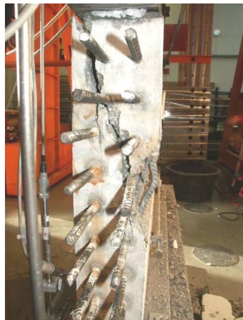
Bild A.2-119. Bruchbild der Scheibe 000 (Ansicht Ost) Fig. A.2-119. Panel 000 at failure (view east)
