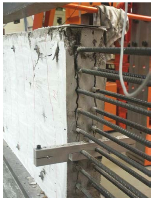
Bild A.1-17. Bruchbild der Scheibe 025T (Ansicht West) Fig. A.1-17. Panel 025T at failure (view west)
