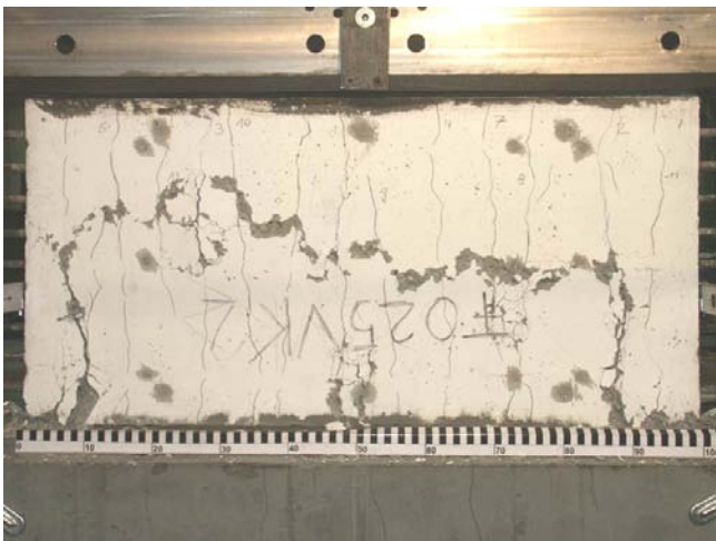
Bild A.4-85. Bruchbild der Scheibe F025VK2 (Ansicht Nord) Fig. A.4-85. Panel F025VK2 at failure (view north)
