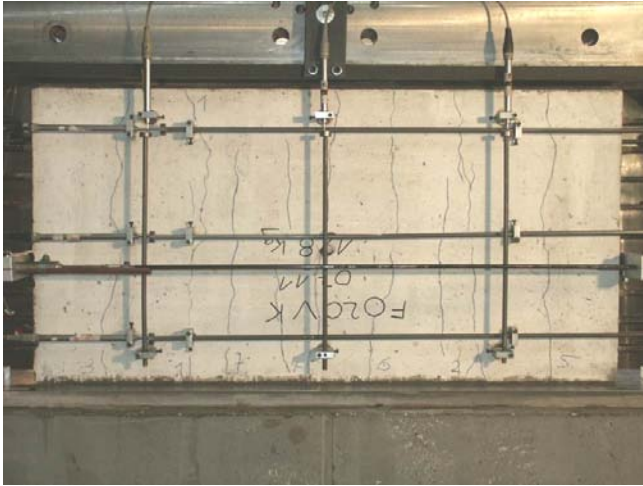
Bild A.2-95. Rissbild der Scheibe F020VK (Ansicht Nord) Fig. A.2-95. Crack pattern of Panel F020VK (view north)
