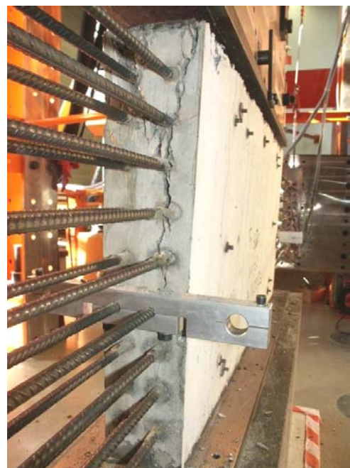
Bild A.2-98. Bruchbild der Scheibe F020VK (Ansicht Ost) Fig. A.2-98. Panel F020VK at failure (view east)
