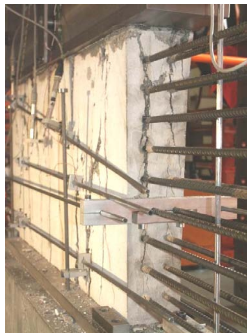
Bild A.2-72. Bruchbild der Scheibe 250VK (Ansicht West) Fig. A.2-72. Panel 250VK at failure (view west)
