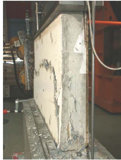
Bild A.4-55. Bruchbild der Scheibe FVK2 (Ansicht West) Fig. A.4-55. Panel FVK2 at failure (view west)
