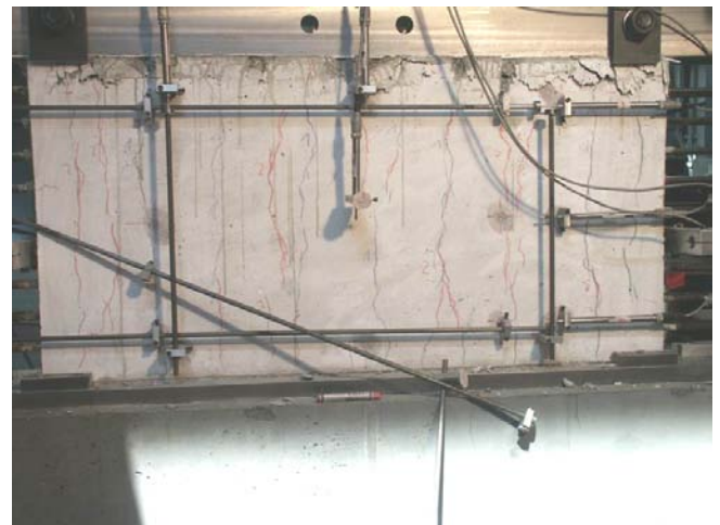
Bild A.1-59. Bruchbild der Scheibe F025T (Ansicht Süd) Fig. A.1-59. Panel F025T at failure (view south)
