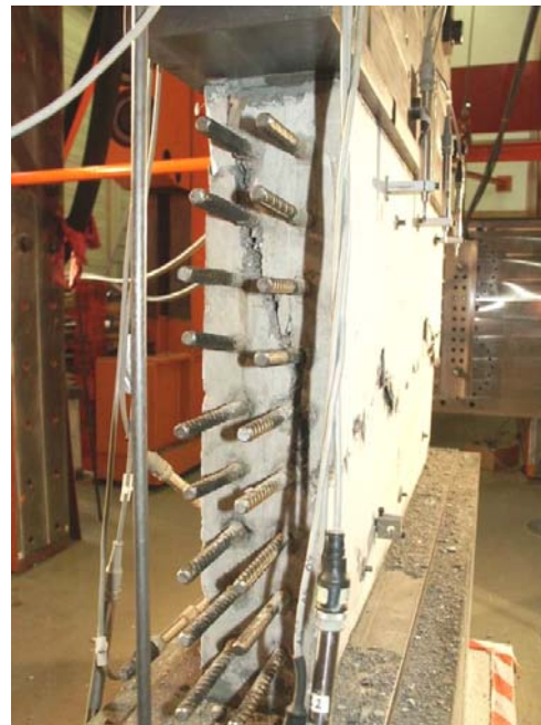
Bild A.2-82. Bruchbild der Scheibe F000VK (Ansicht Ost) Fig. A.2-82. Panel F000VK at failure (view east)
