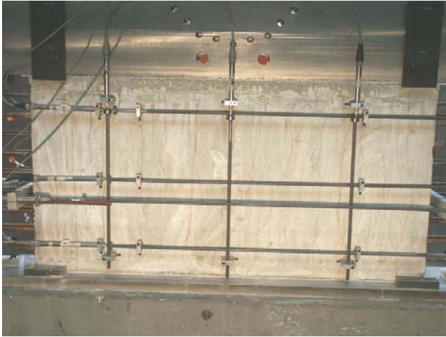
Bild A.1-48. Rissbild der Scheibe FPROPT (Ansicht Nord) Fig. A.1-48. Crack pattern of Panel FPROPT (view north)
