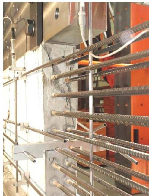
Bild A.1-111. Bruchbild der Scheibe F150 (Ansicht West) Fig. A.1-111. Panel F150 at failure (view west)
