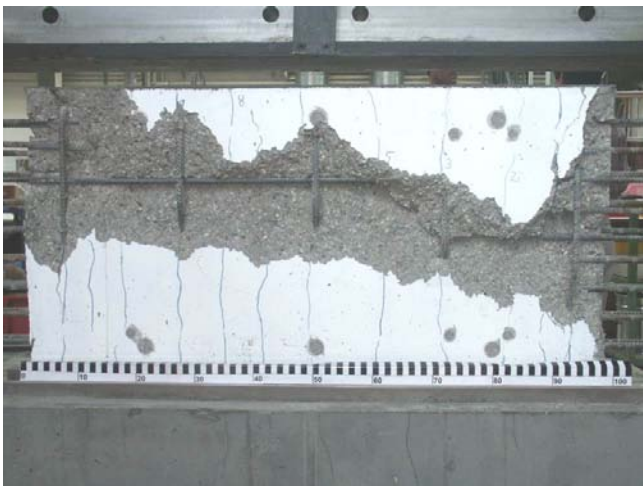
Bild A.4-35. Bruchbild der Scheibe 025VK (Ansicht Süd) Fig. A.4-35. Panel 025VK at failure (view south)
