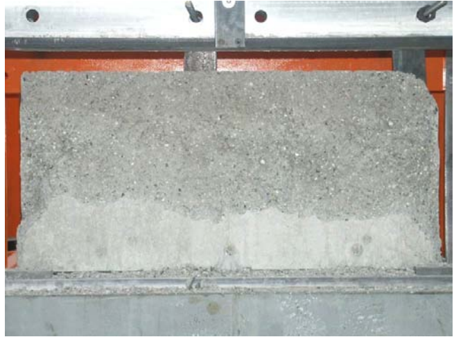
Bild A.4-5. Bruchbild der Scheibe VK6 (Ansicht Nord) Fig. A.4-5. Panel VK6 at failure (view north)
