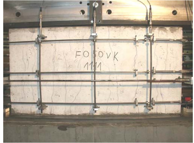
Bild A.2-104. Rissbild der Scheibe F050VK (Ansicht Süd) Fig. A.2-104. Crack pattern of Panel F050VK (view south)
