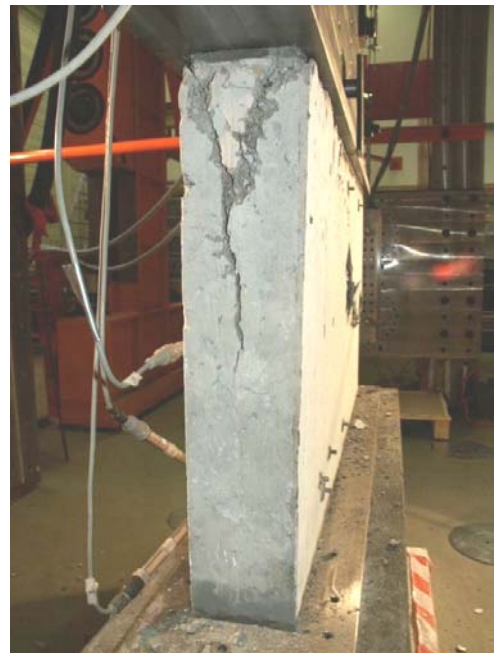
Bild A.2-77. Bruchbild der Scheibe FVK (Ansicht Ost) Fig. A.2-77. Panel FVK at failure (view east)
