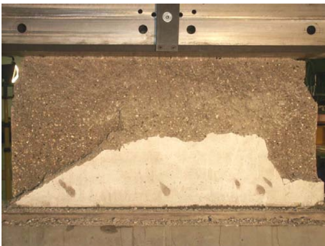
Bild A.2-17. Bruchbild der Scheibe VK4 (Ansicht Süd) Fig. A.2-17. Panel VK4 at failure (view south)
