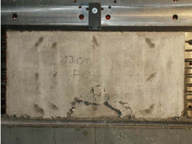
Bild A.3-2. Bruchbild der Scheibe F000VK2 (Ansicht Nord) Fig. A.3-2. Panel F000VK2 at failure (view north)
