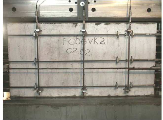
Bild A.3-27. Rissbild der Scheibe F050VK2 (Ansicht Süd) Fig. A.3-27. Crack pattern of Panel F050VK2 (view south)
