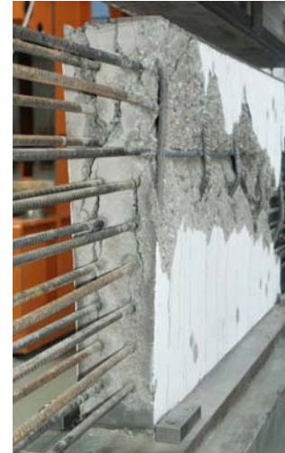
a) Ausknicken der vertikalen Querbewehrung und Absprennen der Betondeckung (Scheibe 025VK) a) buckling of the vertical reinforcement and spalling of the concrete cover (Panel 025VK)
