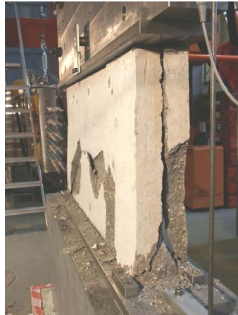
Bild A.2-11. Bruchbild der Scheibe VK3 (Ansicht West) Fig. A.2-11. Panel VK3 at failure (view west)
