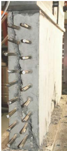
Bild 6-11. Typische Bruchbilder faserbewehrter Stahlbetonscheiben der Serie 3 Fig. 6-11. Typical failure patterns of reinforced steel fibre concrete panels of Series 3
