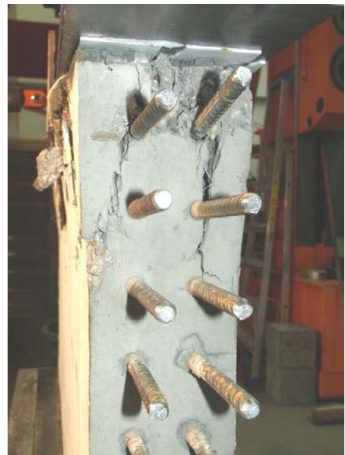
Bild A.3-11. Bruchbild der Scheibe F000VKT (Ansicht Ost) Fig. A.3-11. Panel F000VKT at failure (view east)
