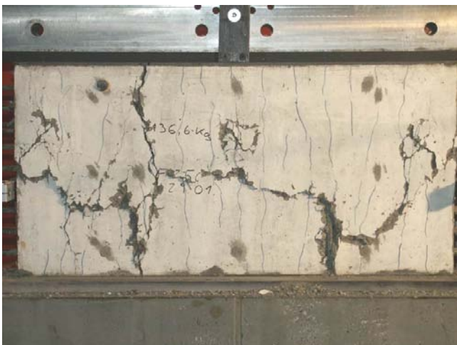
Bild A.3-36. Bruchbild der Scheibe F250VK2 (Ansicht Nord) Fig. A.3-36. Panel F250VK2 at failure (view north)
