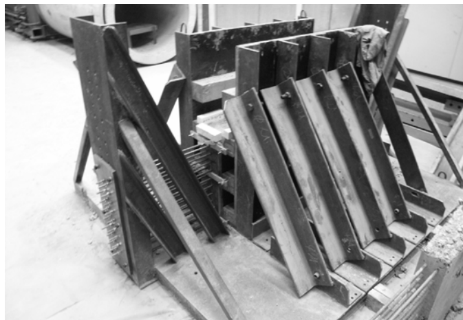
Bild 3-2. Schalung der Versuchsscheiben
