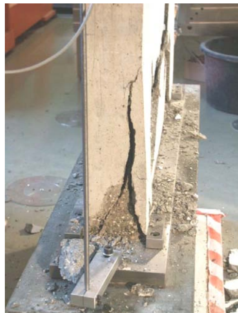
Bild A.2-13. Bruchbild der Scheibe VK3 (Ansicht Ost) Fig. A.2-13. Panel VK3 at failure (view east)
