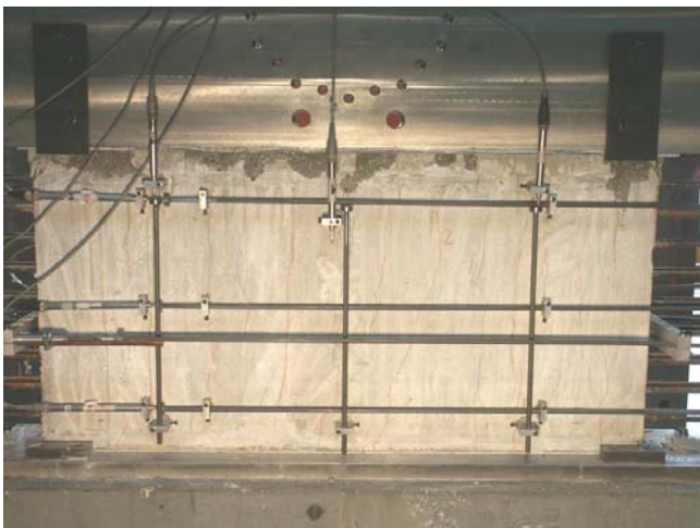
Bild A.1-50. Bruchbild der Scheibe FPROPT (Ansicht Nord) Fig. A.1-50. Panel FPROPT at failure (view north)
