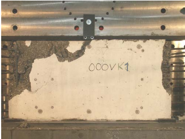
Bild A.2-19. Bruchbild der Scheibe 000VK1 (Ansicht Nord) Fig. A.2-19. Panel 000VK1 at failure (view north)
