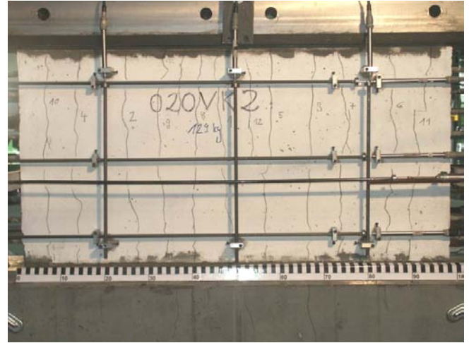
Bild A.4-26. Rissbild der Scheibe 020VK2 (Ansicht Süd) Fig. A.4-26. Crack pattern of Panel 020VK2 (view south)
