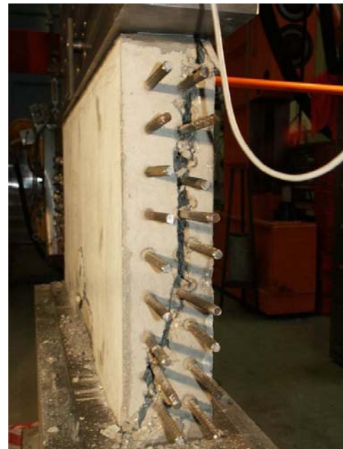
Bild A.3-3. Bruchbild der Scheibe F000VK2 (Ansicht West) Fig. A.3-3. Panel F000VK2 at failure (view west)
