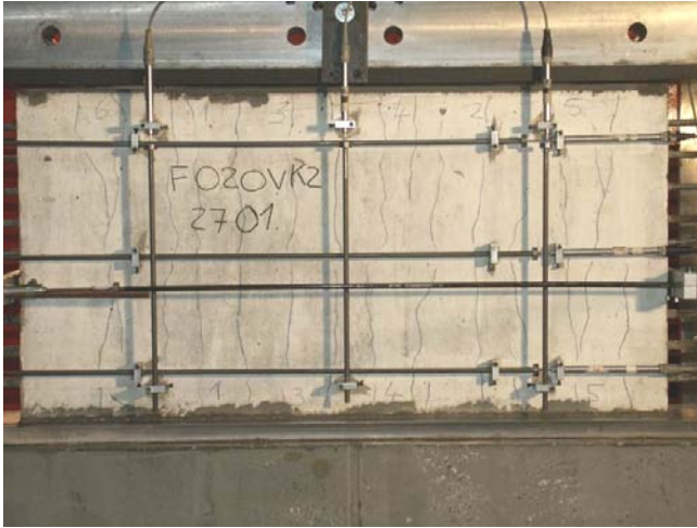
Bild A.3-18. Rissbild der Scheibe F020VK2 (Ansicht Nord) Fig. A.3-18. Crack pattern of Panel F020VK2 (view north)
