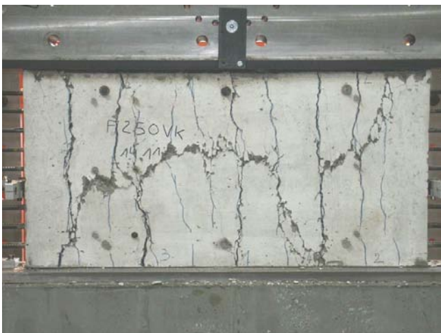
Bild A.2-113. Bruchbild der Scheibe F250VK (Ansicht Nord) Fig. A.2-113. Panel F250VK at failure (view north)
