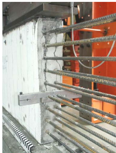
Bild A.4-44. Bruchbild der Scheibe 050VK2 (Ansicht West) Fig. A.4-44. Panel 050VK2 at failure (view west)
