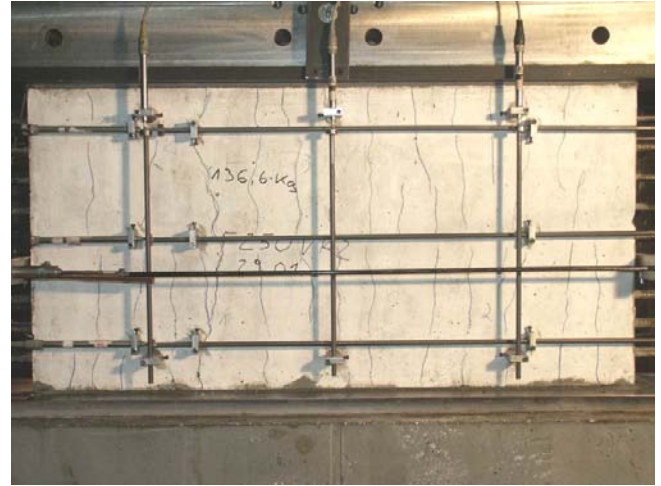
Bild A.3-35. Rissbild der Scheibe F250VK2 (Ansicht Süd) Fig. A.3-35. Crack pattern of Panel F250VK2 (view south)
