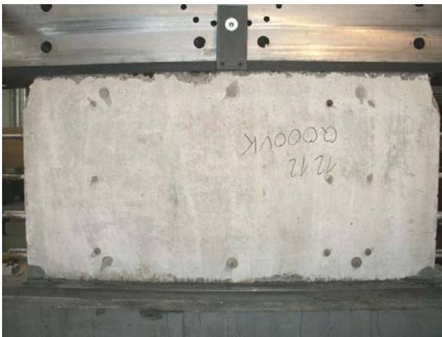
Bild A.2-123. Bruchbild der Scheibe Q000VK (Ansicht Süd) Fig. A.2-123. Panel Q000VK at failure (view south)
