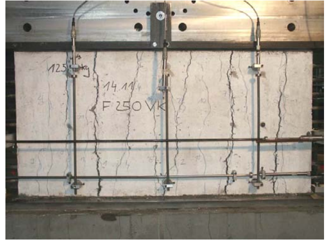
Bild A.2-112. Rissbild der Scheibe F250VK (Ansicht Süd) Fig. A.2-112. Crack pattern of Panel F250VK (view south)
