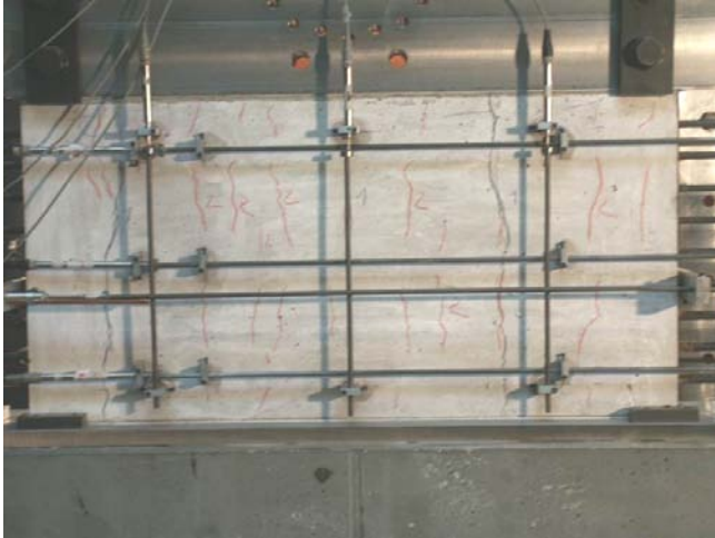
Bild A.1-64. Rissbild der Scheibe F050T (Ansicht Nord) Fig. A.1-64. Crack pattern of Panel F050T (view north)
