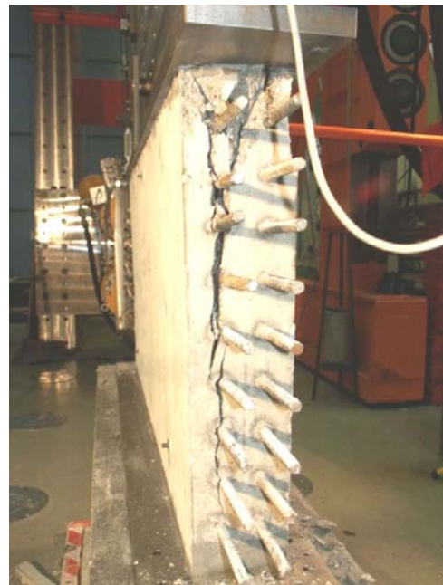
Bild A.2-30. Bruchbild der Scheibe 000VK3 (Ansicht West) Fig. A.2-30. Panel 000VK3 at failure (view west)
