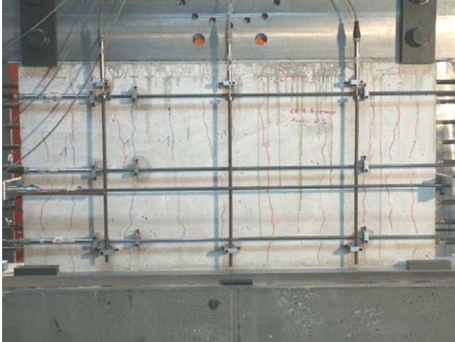
Bild A.1-56. Rissbild der Scheibe F025T (Ansicht Nord) Fig. A.1-56. Crack pattern of Panel F025T (view north)
