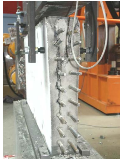
Bild A.4-10. Bruchbild der Scheibe 000VK4 (Ansicht West) Fig. A.4-10. Panel 000VK4 at failure (view west)
