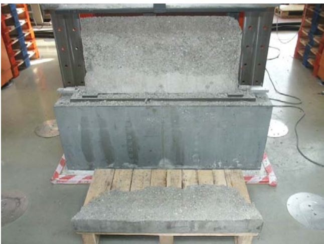
Bild A.4-6. Bruchbild der Scheibe VK6 (Ansicht Nord) Fig. A.4-6. Panel VK6 at failure (view north)
