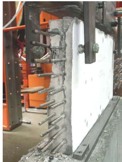
Bild A.4-12. Bruchbild der Scheibe 000VK4 (Ansicht Ost) Fig. A.4-12. Panel 000VK4 at failure (view east)
