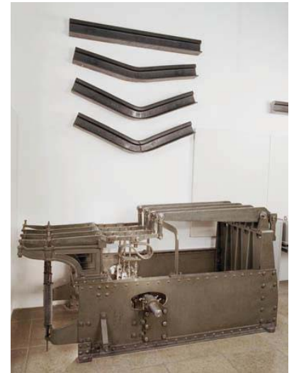
Dauerzugversuchsmaschine von August Wöhler, Quelle: Deutsches Museum
