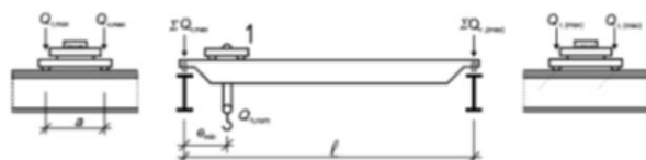
a) Lastanordnung des belasteten Krans zur Bestimmung der maximalen Belastung des Kranbahnträgers
