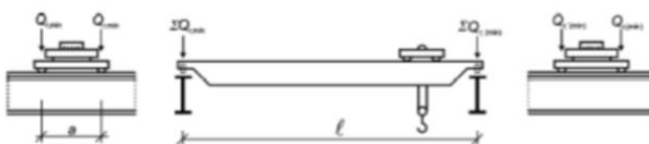
Lastanordnung des belasteten Krans zur Bestimmung der minimalen des Kranbahnträgers nach DIN EN 1991-3 (Bild 2.1)
