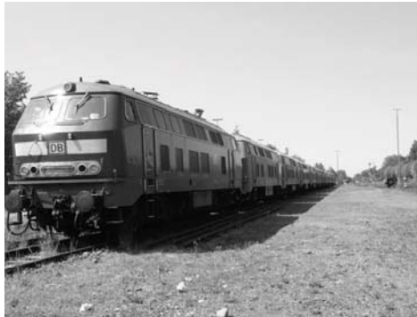
Belastungszug, bestehend aus 10 Loks BR 218
