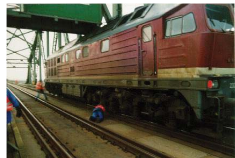
Durchführung von Belastungsversuchen LTS M62 „Taigatrommel“
